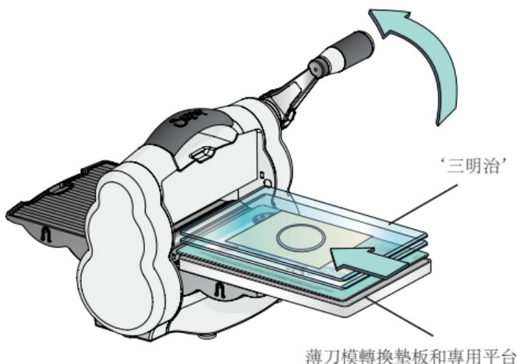
2. 請把需要裁切的‘三明治’放置在薄刀模轉換墊板和專用平台上，慢慢推入Big Shot Foldaway折疊紙藝機裡。注意請按照同一方向轉動手柄直到整個‘三明治’通過滾軸。移除專用平台，拿出已裁剪好的形狀！
