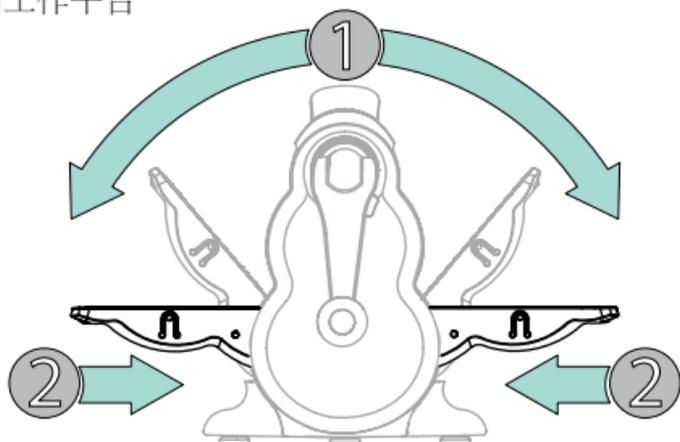
打開機器，您需要 (1) 使用手指凹槽作為導向，從中心拉下平台。(2) 一旦水平，將兩個平台推向機器的中心以鎖定到位。要折疊起來，用兩手抓住平台中心，往外拉，拉出來以後，可以折疊起來。
