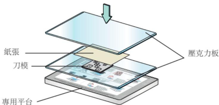
1. 請把Sizzlits刀模泡綿面朝上平放在壓克力板上，在刀模上放置紙張，然後再放上另一片壓克力板，這樣製作出需要裁切的‘三明治’。
