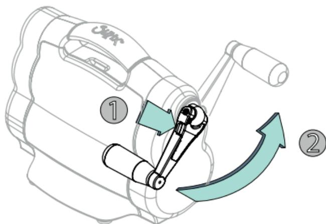
開始使用機器，您需要 (1) 按下曲軸上的鎖鍵按鈕釋放手柄。(2) 將手柄垂直拉起並將其向下拉出，使其與機器平行。一旦曲軸就位，手柄將自動鎖定到位。要存放，請按下鎖鍵按鈕將手柄從鎖定位置鬆開扭轉後還原到收納時的固定位。
