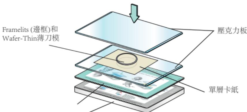
同時使用薄刀模轉換墊板和專用平台
